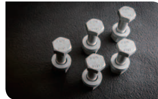
▼ 마찰 접합용 육각 볼트 세트 Friction Grip Type Hexagonal Bolt Set M12-M30 KS B 1010, JIS 1186 ISO 14399-3/14399-4 available(optional)
